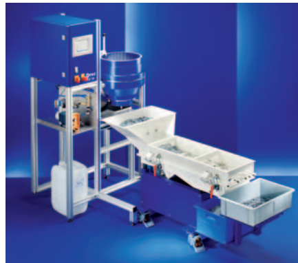
Máquina centrífuga de plato modelo CF con UNISEPA Machine à plateau à force centrifuge CF avec UNISEPA
